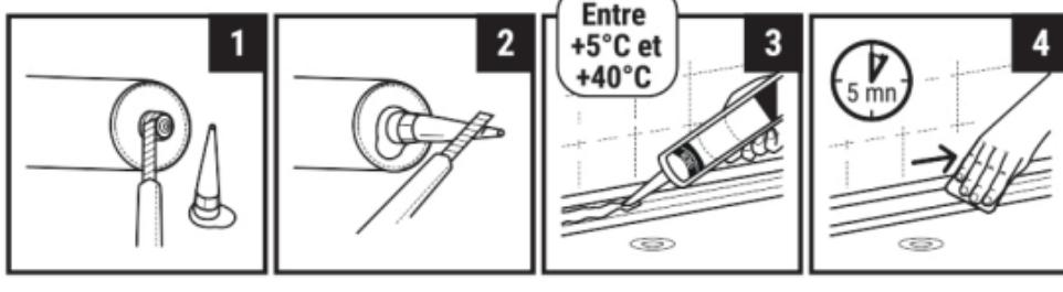
Couper l'embout, visser la canule et la couper en biseau suivant la largeur de joint désirée.
