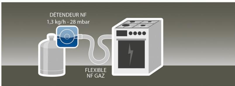
► Dans ce cas, un seul détendeur à sécurité directement installé sur la bouteille est nécessaire. Il alimente la plaque de cuisson ou la gazinière. Le raccordement est réalisé par un flexible inox ou 10 ans.
