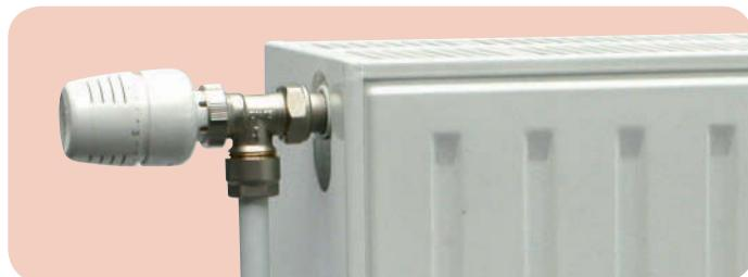
Les robinets thermostatiques permettent de réguler la température pièce par pièce. Les thermostatisables permettent soit un réglage manuel, soit un réglage thermostatique par le simple fait de remplacer la tête manuelle par une tête thermostatique. Ils assurent ainsi la même fonction que les robinets thermostatiques.
