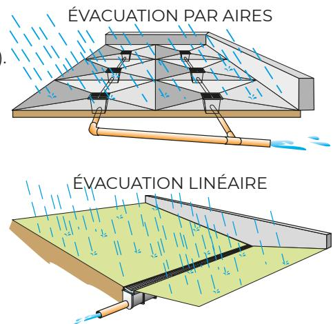
La facilité d'emploi des produits en PVC de First Plast permet de créer un réseau de drainage dans n'importe quel lieu et surface. Il est indispensable de connaître le volume d'eau pluviale pour projeter un réseau d'évacuation approprié.
