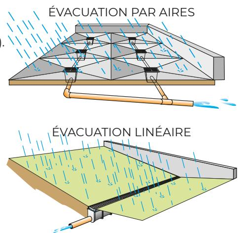
La facilité d'emploi des produits en PVC de First Plast permet de créer un réseau de drainage dans n'importe quel lieu et surface. Il est indispensable de connaître le volume d'eau pluviale pour projeter un réseau d'évacuation approprié.
