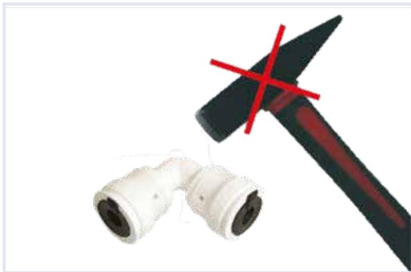
Il n'est pas autorisé d'installer des raccord et / ou des tubes avec d'autres outils que ceux mentionnés dans ce manuel technique.
