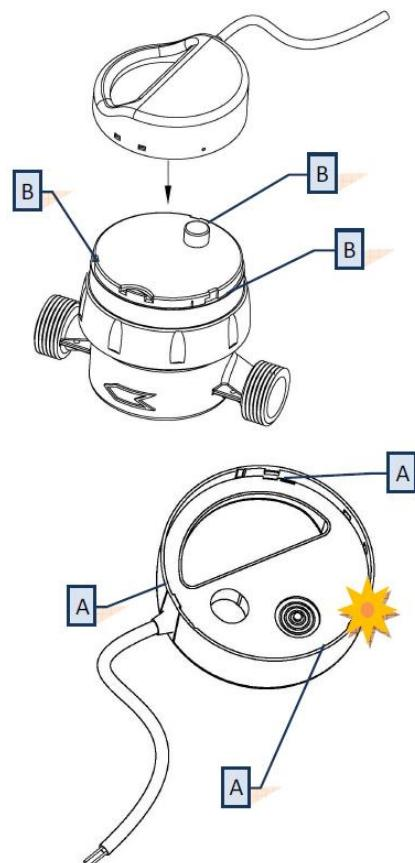
Accrocher le module sur le compteur comme indiqué ci-dessus, les 3 dents A doivent être insérées dans les 3 fentes B. Puis tourner le module dans le sens horaire pour assurer le maintien de l'émetteur sur le compteur.
