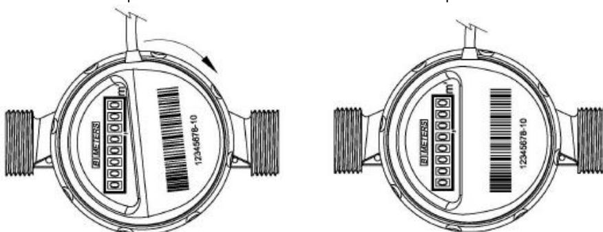
A ce stade, on peut brancher les câbles au réseau MBUS. Pour vérifier le fonctionnement, interroger l'adresse secondaire qui est écrite sur le module ou le configurer avec l'utilisation du concentrateur ou d'un logiciel M-BUS.
