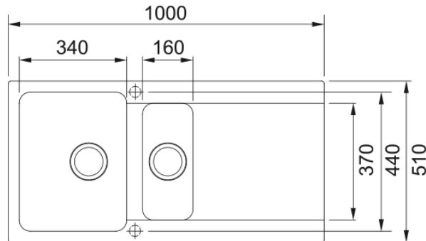
Evier ORION, OID 651 Carbone, à encastrer 1000x510 mm. Sa matière Tectonite avec sa surface non poreuse facilite le nettoyage et garantit une hygiène maximale. Vidage manuel, trop plein rond avec sa bonde, tous ces accessoires qui permettent une installation en toute tranquillité.
