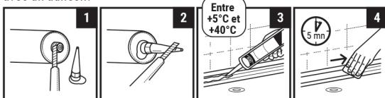
Couper l'embout, visser la canule et la couper en biseau suivant la largeur de joint désirée.
