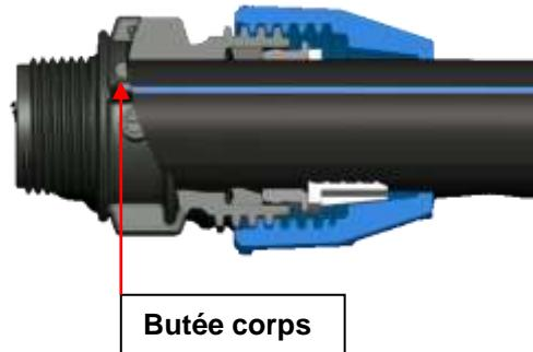
• **Serrer l'écrou pour bloquer le tube**
