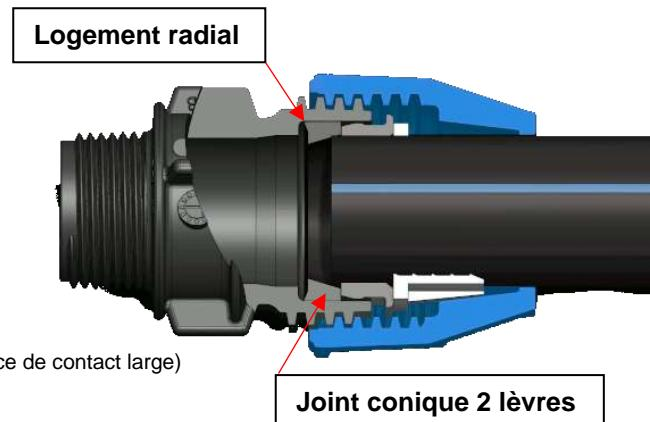
• **Insertion du tube jusqu'à la 2° butée**
