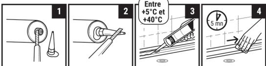
Couper l'embout, visser la canule et la couper en biseau suivant la largeur de joint désirée.
