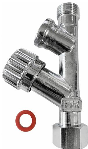
ACCESOIRE ROBINET, Kit anti-particule avec filtre intégré, avec robinet d'arrêt intégré, entrée 3/8 femelle, sortie 3/8 mâle, filtre métallique 500 microns, 90 degrés,
