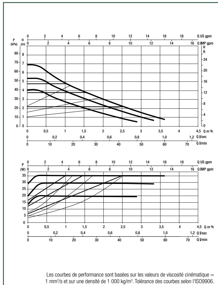
Les courbes de performance sont basées sur les valeurs de viscosité cinématique = 1 mm<sup>2</sup>/s et sur une densité de 1 000 kg/m<sup>3</sup>. Tolérance des courbes selon l'ISO9906.
