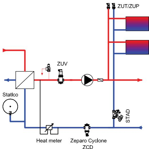
Le séparateur de boues Zeparo Cyclone sera installé en ligne sur le retour, en amont de l'équipement à protéger ou en amont de la source d'énergie calorifique/frigorifique. Aucune distance minimale n'est requise entre le Zeparo Cyclone et les coude et tés sur la tuyauterie.
