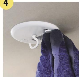
Finition : mise en place des caches de tête de vis
