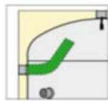
Les crosses de prélèvement permettent de puiser l'eau aux points les plus hauts, donc les plus chauds.
