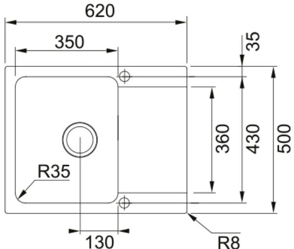
Evier ORION, OID 611-62 Urban grey, à encastrer 620x500 mm. Sa matière Tectonite avec sa surface non poreuse facilite le nettoyage et garantit une hygiène maximale. Vidage manuel, trop plein rond avec sa bonde, tous ces accessoires qui permettent une installation en toute tranquillité.
