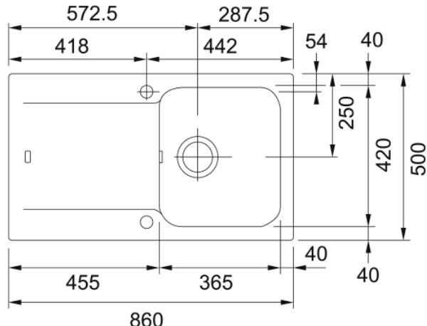
Evier KITE , KITE 611-86 Blanc, à encastrer 860x500 mm. Sa matière Tectonite avec sa surface non poreuse facilite le nettoyage et garantit une hygiène maximale. Vidage manuel, trop plein rond avec sa bonde, tous ces accessoires qui permettent une installation en toute tranquillité.
