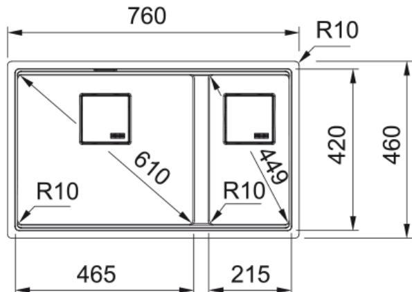
Cuve KUBUS 2.0, KNG 120 Noir mat, sous-plan 760x460 mm. Sa matière Fragranite résiste aux rayures, aux chocs et aux taches. Vidage manuel, trop-plein discret, cache bonde carré inox inclus, Bouton push inox tous ces accessoires qui permettent une installation en toute tranquillité.
