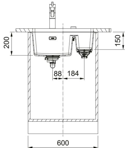
Cuve MARIS, MRG 160-34-15 PBD Blanc, sous-plan 553x433 mm. Sa matière Fragranite résiste aux rayures, aux chocs et aux taches. Vidage automatique, trop plein, Bouton rotatif chrome, tous ces accessoires qui permettent une installation en toute tranquillité.
