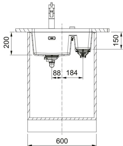
Cuve MARIS, MRG 160-34-15 PBD Stone, sous-plan 553x433 mm. Sa matière Fragranite résiste aux rayures, aux chocs et aux taches. Vidage automatique, trop plein, Bouton rotatif chrome, tous ces accessoires qui permettent une installation en toute tranquillité.
