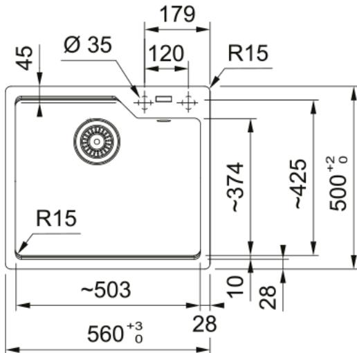
Cuve URBIS, UBG 610-50 Noir mat, à encastrer 560x500 mm. Sa matière Fragranite résiste aux rayures, aux chocs et aux taches. Vidage automatique, Trop plein rond avec sa bonde, tous ces accessoires qui permettent une installation en toute tranquillité.
