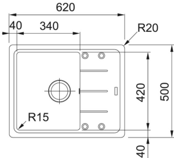
Evier BASIS, BFG 611-62 Noir mat, à encastrer 620x500 mm. Sa matière Fragranite résiste aux rayures, aux chocs et aux taches. Vidage manuel, Trop plein rond avec sa bonde, tous ces accessoires qui permettent une installation en toute tranquillité.
