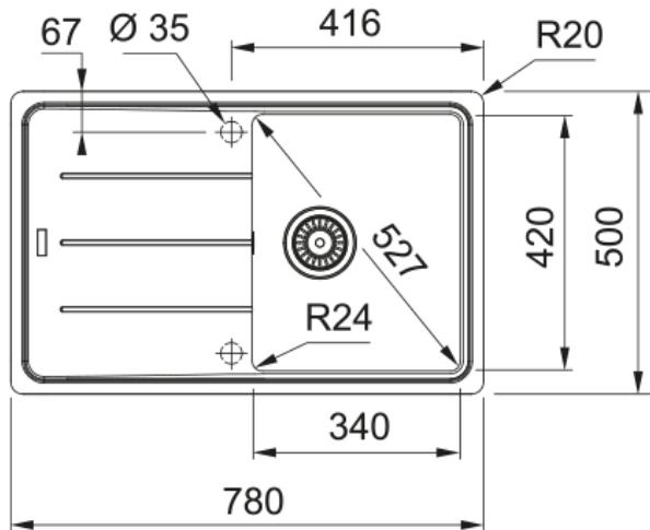
Evier BASIS, BFG 611-78 Noir mat, à encastrer 780x500 mm. Sa matière Fragranite résiste aux rayures, aux chocs et aux taches. Vidage manuel, Trop plein rond avec sa bonde, tous ces accessoires qui permettent une installation en toute tranquillité.
