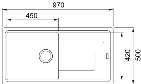
Evier TITAN, TTD 611-97 Platinum, à encastrer 970x500 mm. Sa matière Tectonite avec sa surface non poreuse facilite le nettoyage et garantit une hygiène maximale. Vidage manuel, trop plein rond avec sa bonde, tous ces accessoires qui permettent une installation en toute tranquillité.
