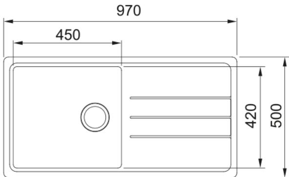
Evier OPALE, OPALE 611-97 Platinum, à encastrer 970x500 mm. Sa matière Tectonite avec sa surface non poreuse facilite le nettoyage et garantit une hygiène maximale. Vidage manuel, trop plein rond avec sa bonde, tous ces accessoires qui permettent une installation en toute tranquillité.
