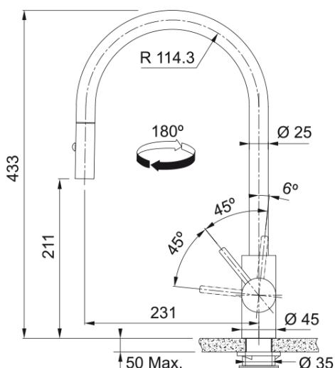
Mitigeur, EOS NEO J douchette double-jet, en inox Noir. Durable, élégant et facile à entretenir. La fonction douchette double-jet composée d'un jet de pulvérisation et d'un jet plus doux et plus large. Vous disposez de l'outil idéal pour un rinçage et nettoyage complet et efficace.
