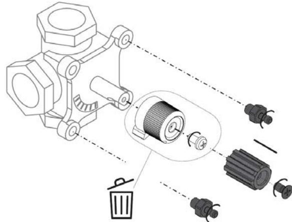
Livré avec le kit d'adaptation pour les vannes ESBE des groupes de mélange MODULFIT®
