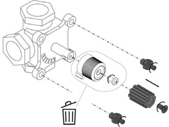
Livré avec le kit d'adaptation pour les vannes ESBE des groupes de mélange MODULFIT®
