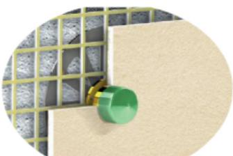
Habiller la grille support d'un treillis plastique. Positionner le bouchon de protection en fonction de l'épaisseur d'enduit prévue. Projeter l'enduit de façade.
