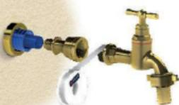
Sortir le tube PER et sa gaine au travers de la grille. Visser, joindre la liaison du robinet à l'aide de téflon\* ou de résine anaérobio. (Filasse proscrite).
