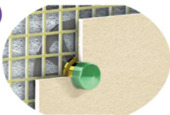
Percer un trou ( $\varnothing$  environ 30mm), Positionner la grille support au centre du perçage (vis pointeau de blocage dirigée vers le bas). Percer et loger les chevilles ( $\varnothing$  8mm). Fixer la grille.
