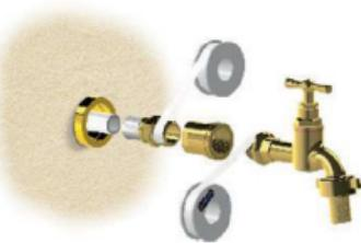
Visser et joindre le robinet sur l'embout à l'aide de téflon® ou de résine anaérobio (filasse proscrite). Visser et joindre le raccord sur l'embout.
