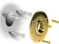
Percer un trou ( $\varnothing$  environ 30mm). Positionner l'applique (vis pointeau de blocage dirigée vers le bas). Percer et loger les chevilles ( $\varnothing$  6mm). Fixer l'applique.
