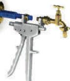
Raccorder le robinet au tube PER selon le type de raccord choisi. (Exemple d'un raccord à glissement).
