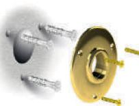
Percer un trou ( $\varnothing$  environ 30mm). Positionner l'applique (vis pointeau de blocage dirigée vers le bas). Percer et loger les chevilles ( $\varnothing$  6mm). Fixer l'applique.
