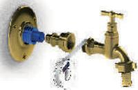
Sortir le tube PER et sa gaine à l'avant de l'applique. Visser le robinet sur l'embout PER, joindre à l'aide de téflon\* ou de résine anaérobie. (Filasse proscrite). Percer et loger les chevilles ( $\varnothing$  6mm). Fixer l'applique.
