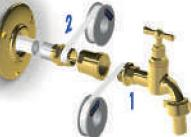
Visser et joindre le robinet sur l'embout à l'aide de téflon\* ou de résine anaérobie. (Filasse proscrite). Visser et joindre le raccord à sertir (U - H - TH) sur l'embout.
