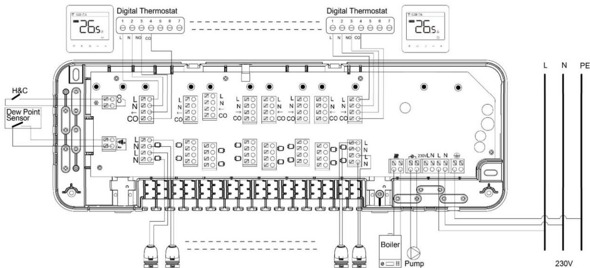
Remarque: Le thermostat doit être Froid/Chaud et avoir une entrée CO (change over) pour cette inversion
