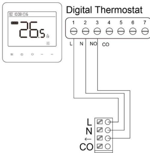
Utiliser le nombre maximum de thermostats et d'actionneurs décrit dans le paragraphe spécifications techniques. Connectez un actionneur par paire de bornes. Si moins de 8 thermostats sont connectés au bornier, les bornes des actionneurs d'autres zones libres peuvent être utilisées. Pour ce faire, un pont (ou plusieurs) est ponté entre la sortie du thermostat NO et les bornes inutilisées de la multiprise. Voir l'exemple suivant:
