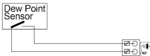
Le cavalier doit être retiré pour connecter le capteur d'humidité.
