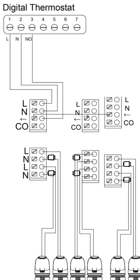
**11 SCHEMA: Câblage froid/chaud avec inversion des thermostats à travers la barrette de connexion**
