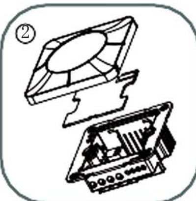
Séparez le panneau avant de la partie qui contient les connexions (qui est le transformateur). Débranchez le câble de la prise
