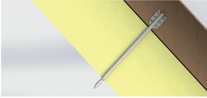
1. Fixer la suspenste sur la charpente
