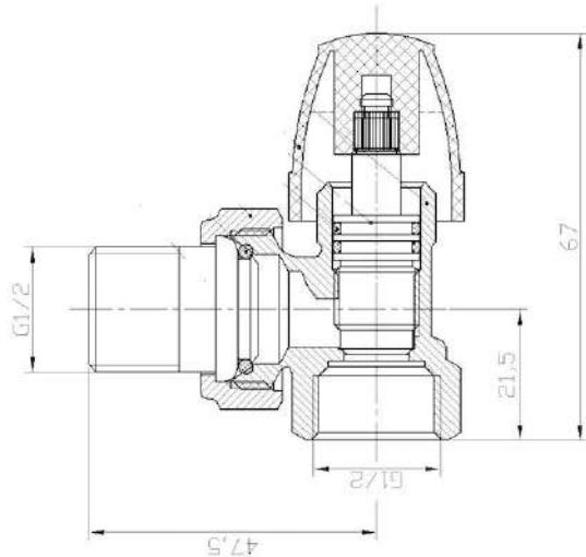
**Description produit :** Le robinet manuel de radiateur 1/2" Equerre M/F est utilisé dans des installations de chauffage à eau chaude avec circulateur
