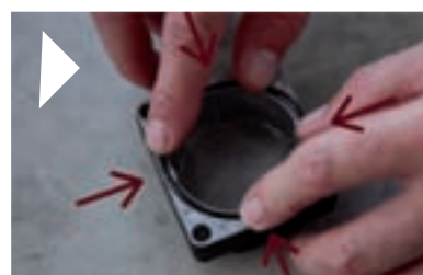
Remplacer le filtre annulaire de la pompe (• 3).
