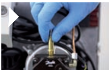
Remplacer l'électrovanne de la pompe (• 5).
