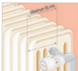
aux radiateurs trop épais (demi-épaisseur maxi.80mm)
