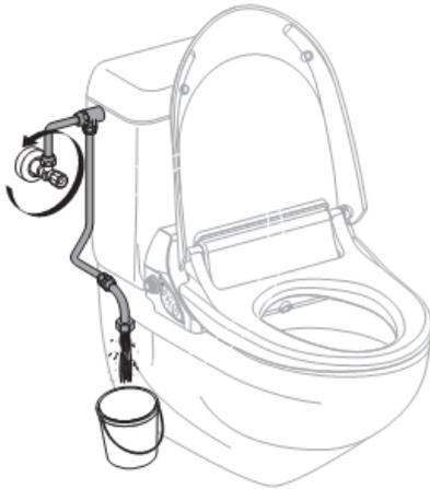
**7** Refermer le robinet équerre, tourner le coude de raccordement vers le haut et le raccorder à l'AquaClean 4000
