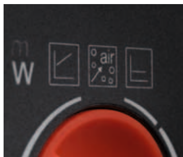
Sans vis : Purge du moteur en mode automatique via le bouton rouge.
