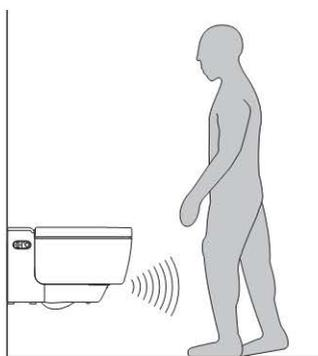
Illustration 1 : Détection par le capteur de proximité
