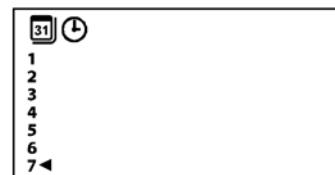
La sélection et la désélection de la fonction se fait par appui successif sur la touche « **+** ».
