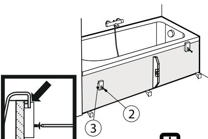
**Attendre le séchage complet de la colle pour assemblage avant de poser le décor ou le carrelage.**
