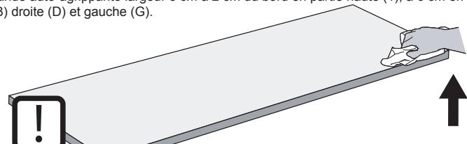
**Nettoyer soigneusement les surfaces avant collage des bandes auto-agrippantes.**
