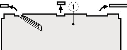
**6. Coller** le joint mousse à la limite du bord supérieur du tablier.
