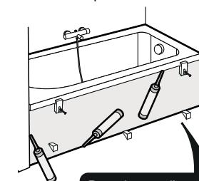
Dans le cas d'un tablier à carreler, coller à l'aide d'une colle flex, la bande armée pour angle sol et mur et maroufler proprement **!**
