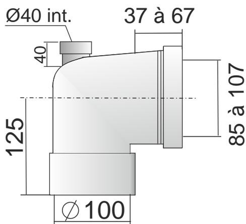
Pipe courte mâle à prise d'air, coudée Ø 100 x L 150 mm en PVC
