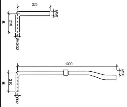
**Assembly / Montage du tube de chasse**
