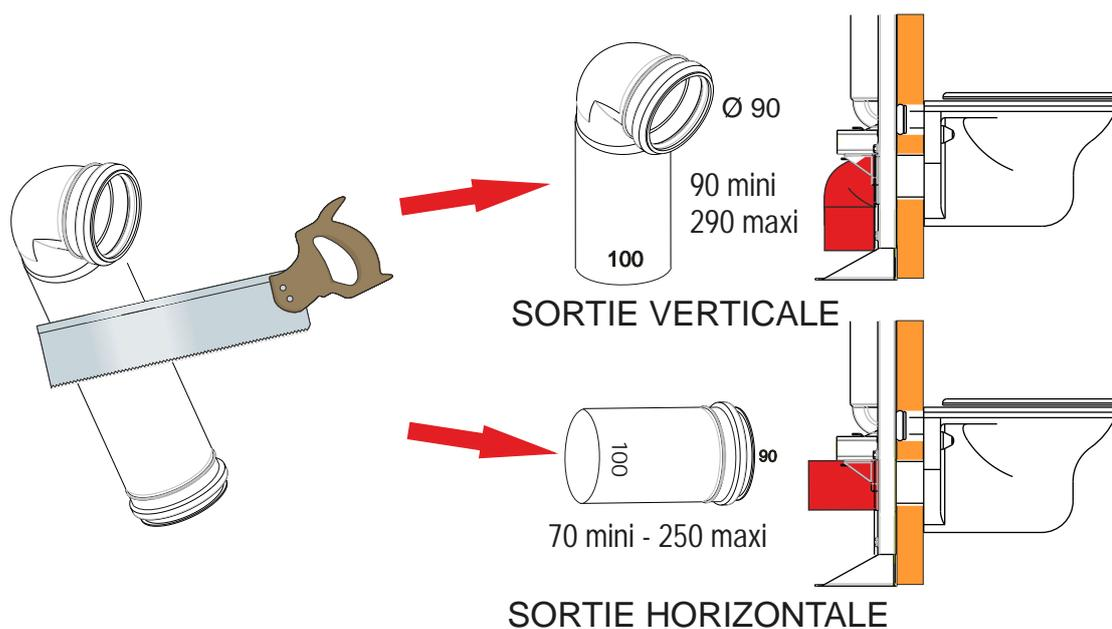
Manchon droit Ø 90 x L 255 mm en PP pour sortie cuvette
