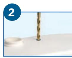
Percer un trou de 10 mm de diamètre à l'endroit indiqué sur le capot de l'appareil.
