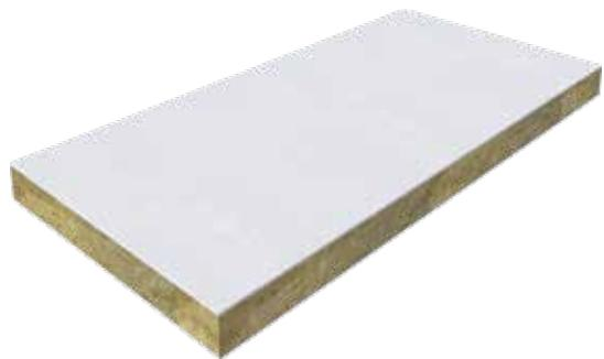
La plaque K-FLEX® K-FIRE 3PBAT50 (160 kg/m<sup>3</sup>) est composée d'une plaque de laine minérale enduite d'une peinture acrylique K-FLEX® K-FIRE COATING . Elle permet de restaurer les performances coupe-feu des murs aux emplacements où ils sont traversés par des pénétrations de service. La plaque K-FIRE 3PBAT50 est conçue pour prévenir le passage de feu et fumées tout en permettant l'installation des éléments de service.
