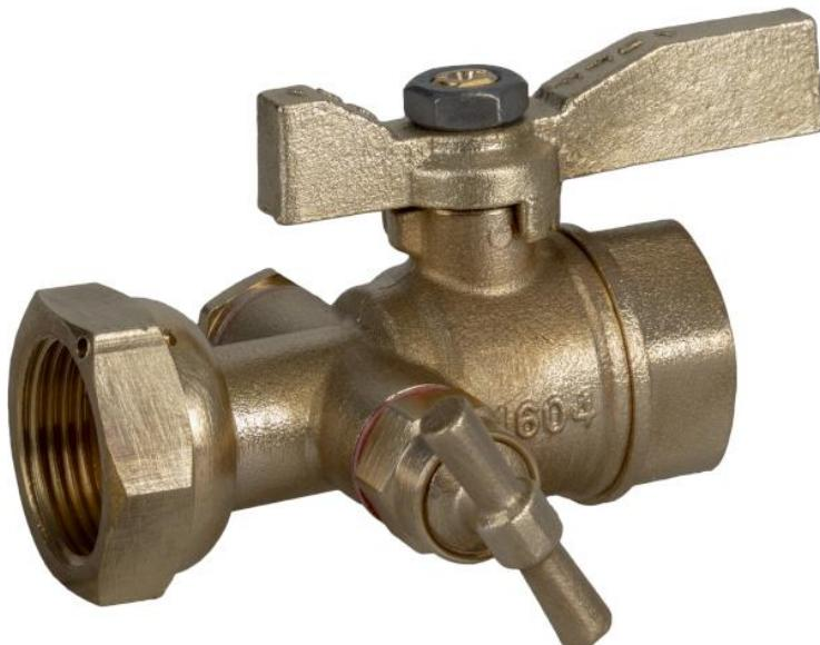
**Dimensions :** DN3/4"**Raccordement :** Femelle, écrou prisonnier BSP**Température Mini :** -10°C**Température Maxi :** +120°C**Pression Maxi :** 20 Bars**Caractéristiques :** Avant ou après compteur
