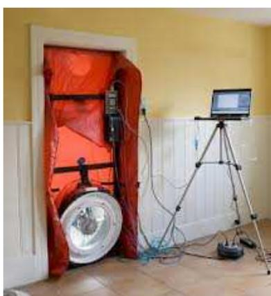
Le traitement de l'étanchéité à l'air permet de diminuer les déperditions énergétiques dues à la convection de l'air, et de limiter la diffusion de vapeur d'eau dans les isolants qui conduirait à créer de la condensation et des moisissures.
