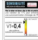
**CERTITA** mesure la valeur de la variation temporelle des têtes thermostatiques. Dans le cadre de la réglementation thermique RT 2012 et de l'utilisation de robinets thermostatiques, cette valeur rentre dans le calcul de la performance énergétique. Plus la valeur est basse, plus la performance de la tête thermostatique est élevée.
